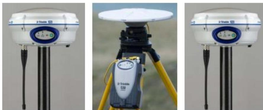
Рисунок 2.2 - Мобильные приемники и базовых станций для RTK (Trimble)
