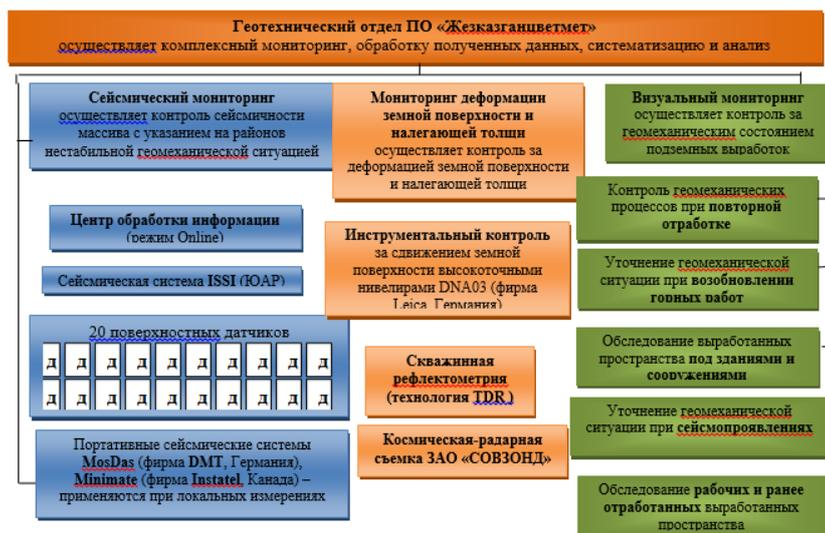
Рисунок 1.8 – Схема геомеханического мониторинга Жезказганского месторождения
